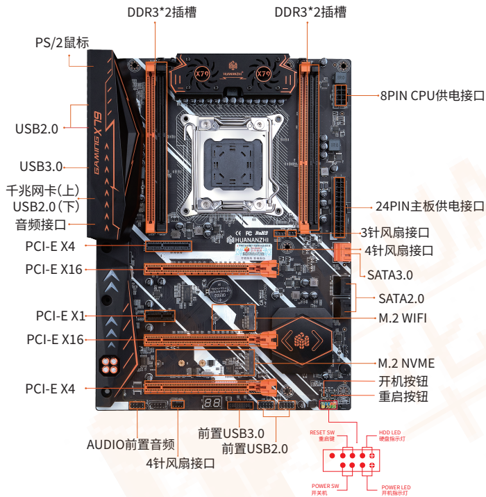
图1-1 X79至尊V7.1主板图解
